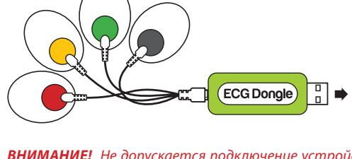
**ВНИМАНИЕ!** Не подключайте провода с электродами непосредственно в разъем micro-USB вашего мобильного устройства!
