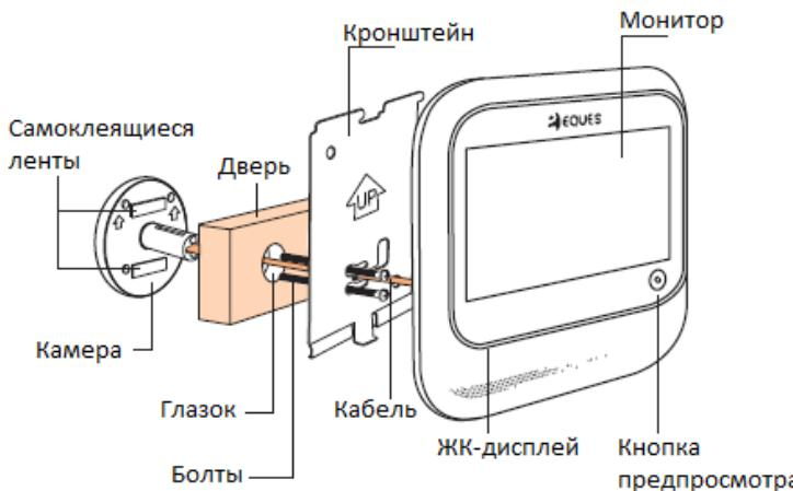
Установка устройства при помощи отвертки за 5 минут.
