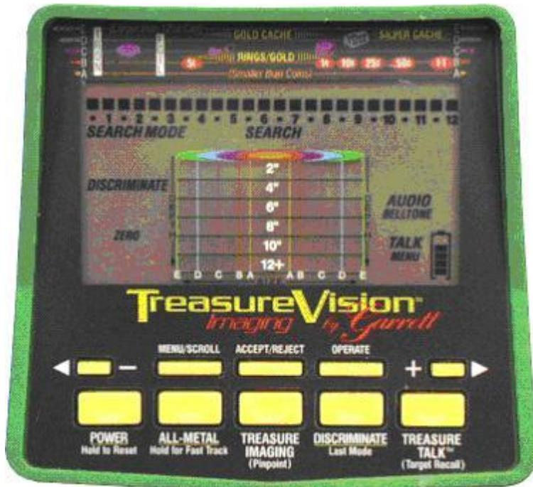
**Power/ Hold to reset:** Включение, выключение прибора, возврат к заводским настройкам.
