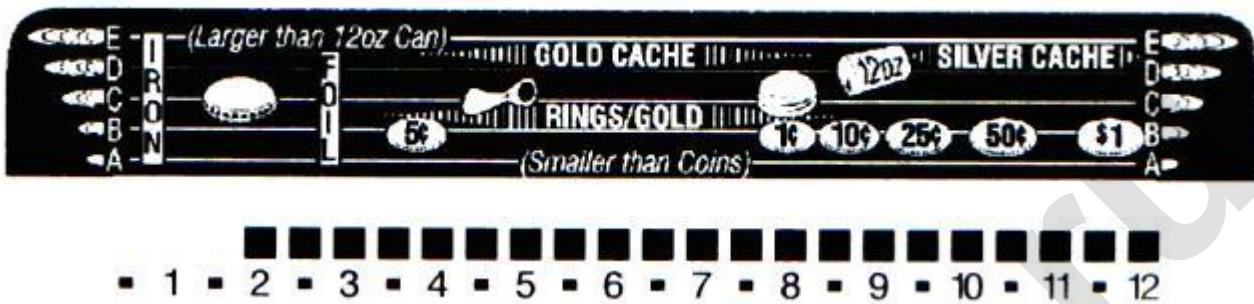
Прибор оборудован высокоэффективной системой определения металлов. В верхней части дисплея имеется схематический рисунок, по которому с большой долей вероятности можно установить какой обнаруженный метал или предмет находится в грунте.
