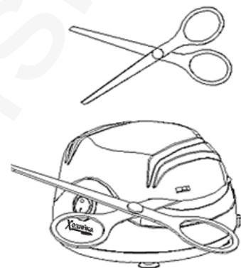
**Внимание:** Если в процессе заточки лезвие ножниц блокирует диск заточки до полной его остановки, следует прекратить процесс и извлечь лезвие из канавки, иначе это может повредить прибор. После 3-х минут использования прибора, во избежание перегрева, отключите его и дайте остыть на протяжении 20 минут.
