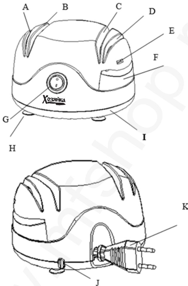
**А.** Левый V-образный канал для стадии грубой заточки. **В.** Правый V-образный канал для стадии грубой заточки. **С.** Левый V-образный канал для стадии доводки. **Д.** Правый V-образный канал для стадии доводки. **Е.** Отверстие для заточки отверткой. **Ф.** Канал для заточки ножниц. **Г.** Тумблер питания. **Н. И.** Основание. **Ж.** Кнопка сворачивания провода. **К.** Провод с вилкой питания.
