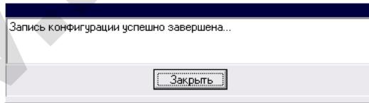
**После записи конфигурации, прибор полностью перезагружается и в течении 10 секунд обмен с прибором не возможен. Необходимо дождаться, когда загорится или замигает индикатор GSM.**
