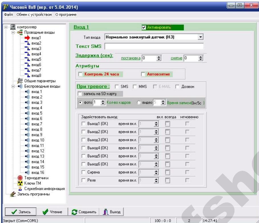
Сначала необходимо включить и настроить все входы на которые будут подключаться проводные датчики (если вы планируете использовать только беспроводные датчики можно переходить сразу к разделу «*Беспроводные датчики*»).
