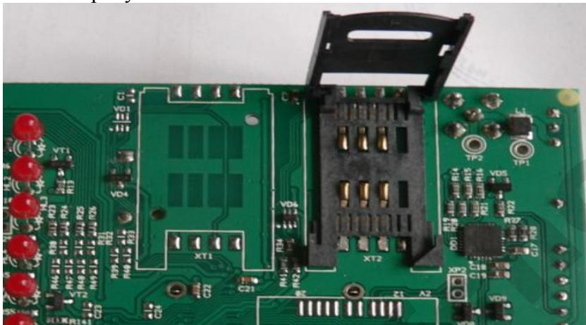
Устанавливаем SIM-карту в крышку слота и закрываем его в порядке обратном открытию.
