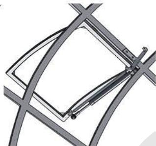
**Установка на подъёмную (вертикальную) форточку с дополнительной планкой**
