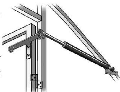
8.1.2. Открыть дверь на требуемую величину (максимальный угол открывания не более 90°) и зафиксировать ее в неподвижном положении подручными средствами. Для уменьшения ветровой нагрузки угол открывания двери нужно уменьшить, например, до 80°.
