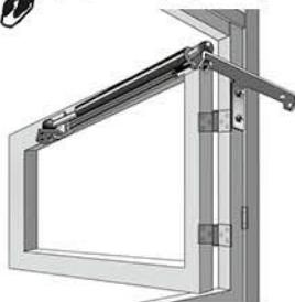
**Установка на форточку с дополнительной планкой**
