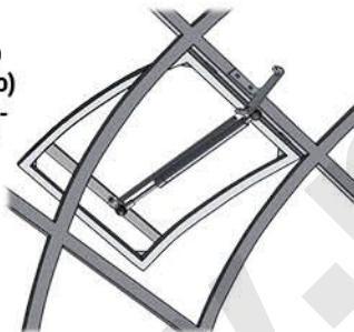
**Примечание.** Установка термопривода на вертикальные/подъемные форточки/фрамуги производится аналогично распашным, с учетом размера и веса конструкции. Угол открывания, для снижения ветровой нагрузки, делать возможно меньшим.
