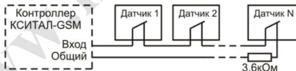
Датчики, имеющие выход типа "нормально разомкнутый сухой контакт" или "открытый коллектор" соединяются параллельно друг с другом и с добавочным резистором.
