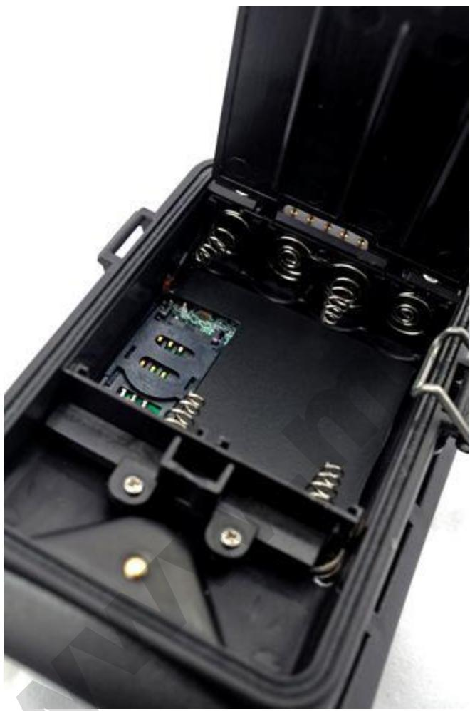
Рисунок 2.1 Аккумуляторный отсек MMS-модуля.
