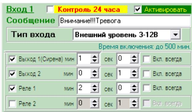
Сирену рекомендуется подключать к выходу «Сирена» т.к. данный выход предназначен специально для сирены и при снятии прибора с охраны отключается.
