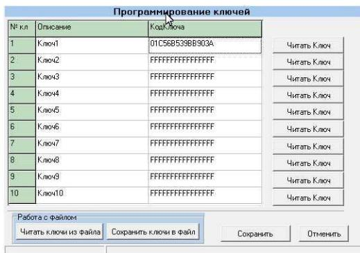
Если ключи уже записаны в Прибор, то можно просто изменить описание ключа. Также можно из программы считать код ключа, или вручную ввести код ключа. Для того, чтобы считать ключ в программу, необходимо нажать кнопку «**Читать ключ**» (Прибор должен быть включен и считыватель ключей должен быть подключен к Прибору).
